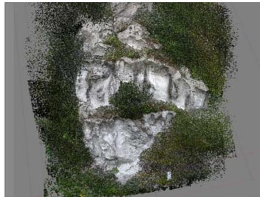
図 2. 椿の白岩の写真から作成した高密度点群
